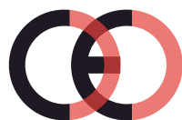
Falsk CE-mærke (for tæt på hinanden)
